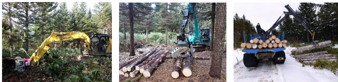
写真1 研究林が保有する高性能林業機械。左からザウルス、プロセッサ、フォワーダ
